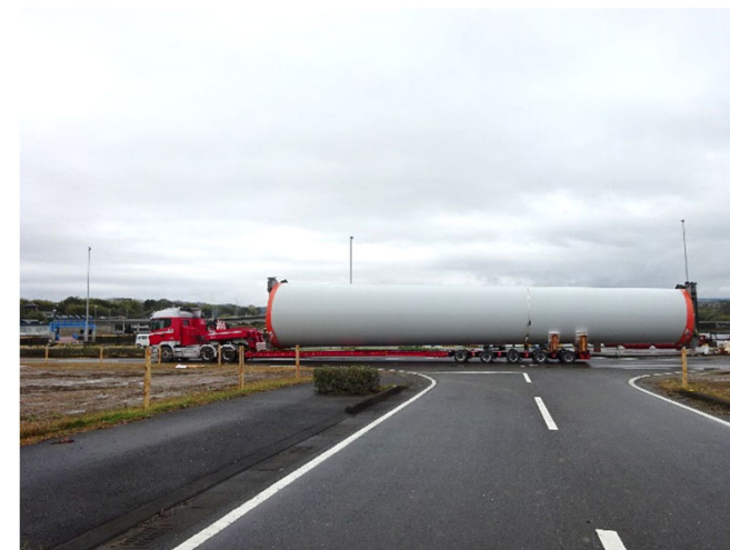
タワー部材輸送
