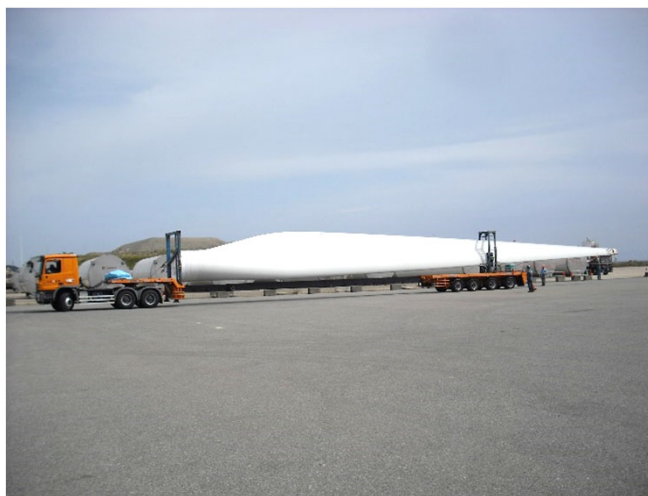
ブレード輸送(1次輸送) 小名浜港～積替え場(落合)
