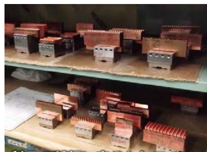
製品の種類に応じた加工ツールをそのつど作っています
