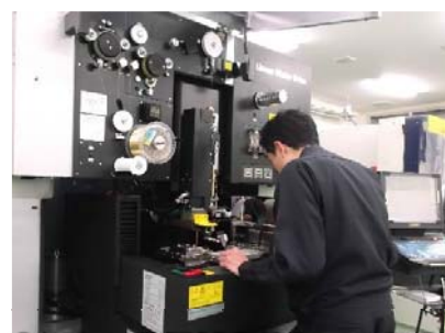
大きな工作機械を使って、細かな溝などをつけていきます
